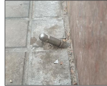
Instal·lació i lectura pern d'anivellació en façana
