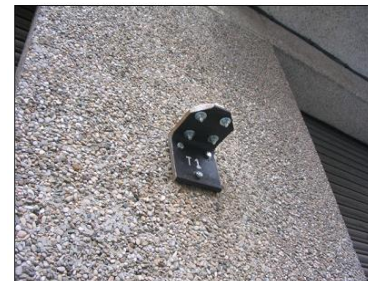
Instal·lació de clinòmetre en façana
