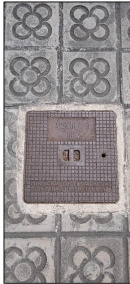
Instal·lació i lectura de fita d'anivellació de terreny en superfície
