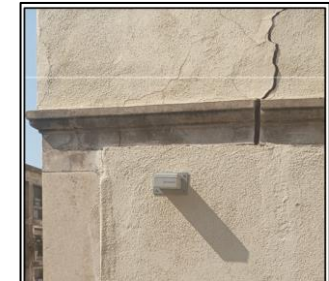
Instal·lació i lectura prismes en façanes. Teodolit de lectura automàtica per a prismes
