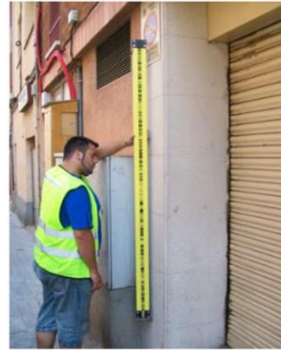
Instal·lació i lectura pern d'anivellació en façana
