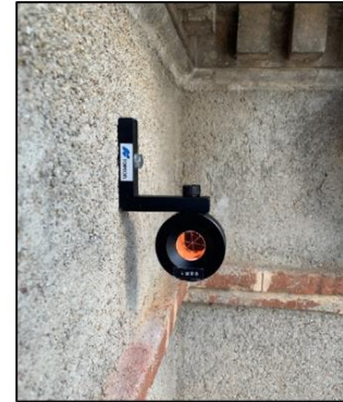
Instal·lació i lectura prismes en façanes. Teodolit de lectura automàtica per a prismes
