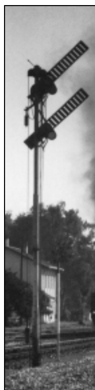
LIBER în direcția II Ziua – două brațe ridicate la 45°, spre dreapta sensului de mers Noaptea – o lumină verde și una galbenă spre tren
