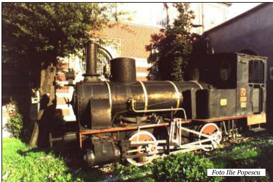
Locomotivă de tipul Bt-n2 fabricată de firma Krauss în 1874, foarte asemănătoare cu “Etelka”.
