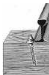
Fixarea șinei pe traversă cu ajutorul unui tirfon.
