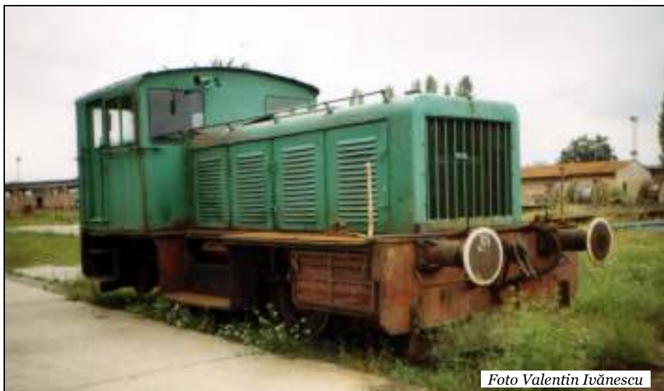
Locomotivă diesel-mecanică din seria 20.000, printre ultimele de acest tip, construită la "Uzinele 23 August", București, în anul 1962.
