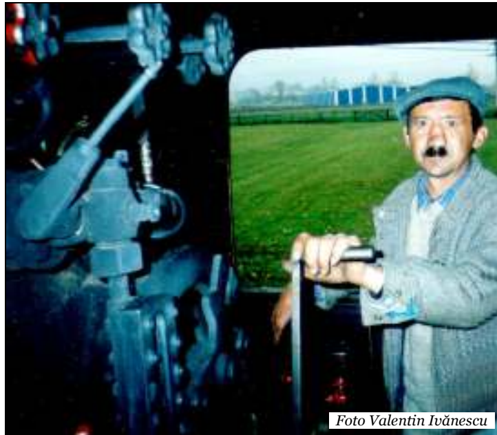
Mecanicul unei locomotive de mărimea lui "Etelka" acționând regulatorul.
