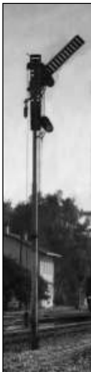
LIBER în direcția I Ziua – brațul de sus ridicat la 45°, spre dreapta sensului de mers Noaptea – o lumină verde, spre tren
