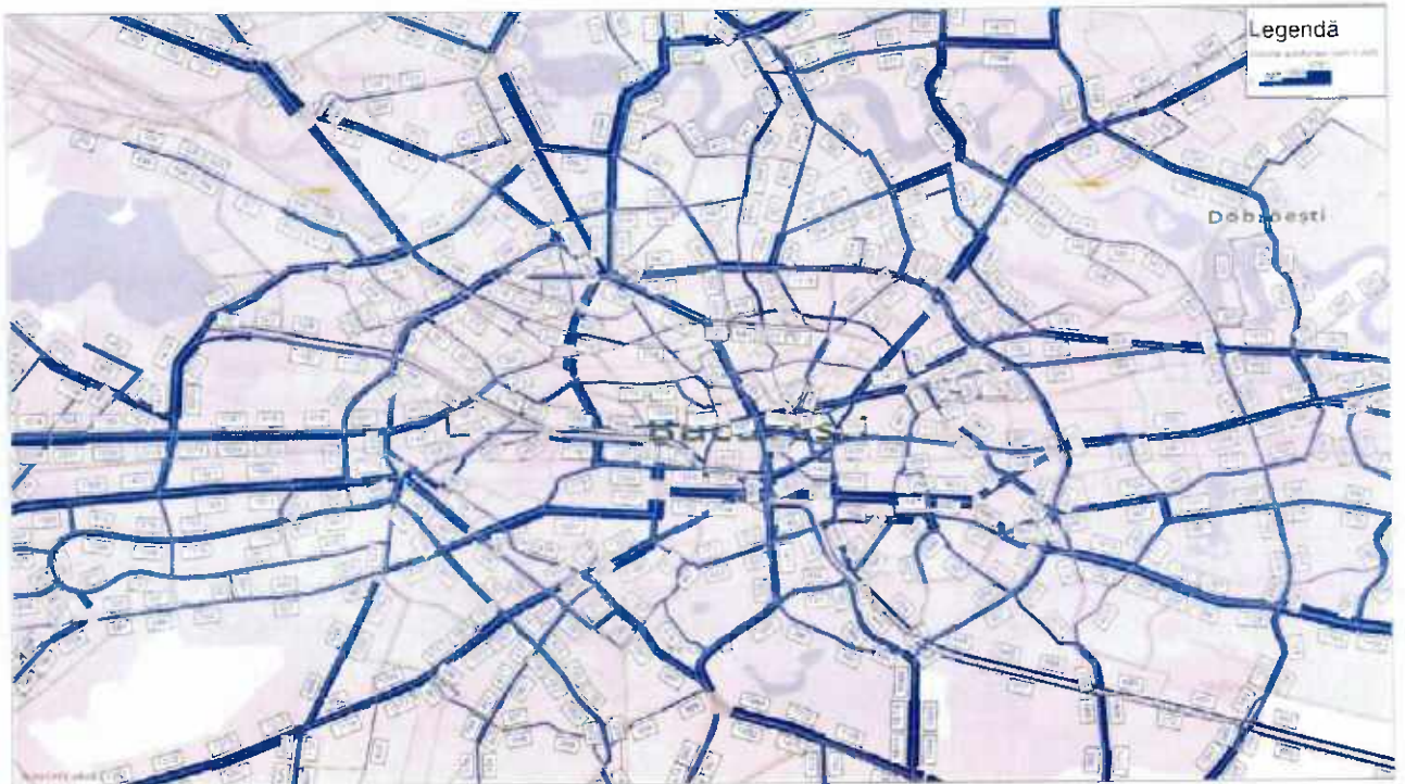
Figura 6.1-1. Volume de trafic, Transport privat, Scenariul fără Proiect, 2029 (Sursa: Modelul de transport)
