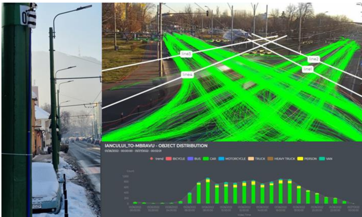
Figura 2.5-2. Procesare date contorizare vehicule folosind AI
