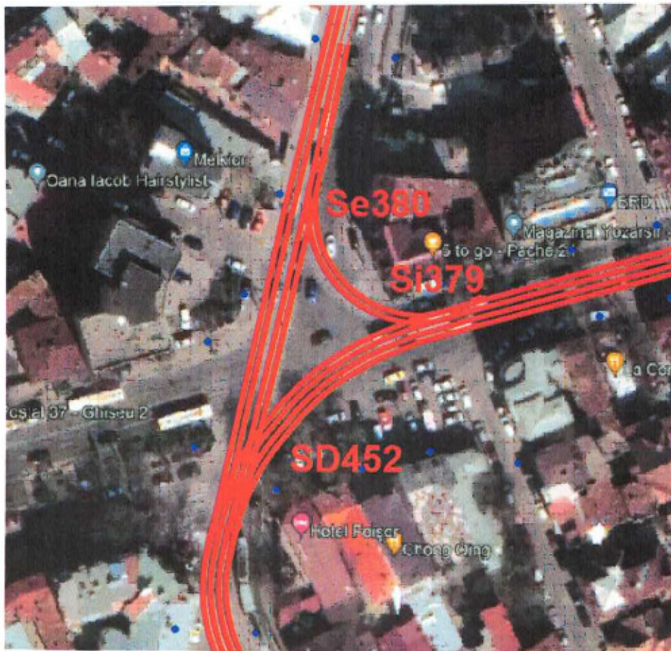
Figura 6. Poziționarea aparatelor de cale în intersecția dintre b-dul Pache Protopopescu și strada Traian.
