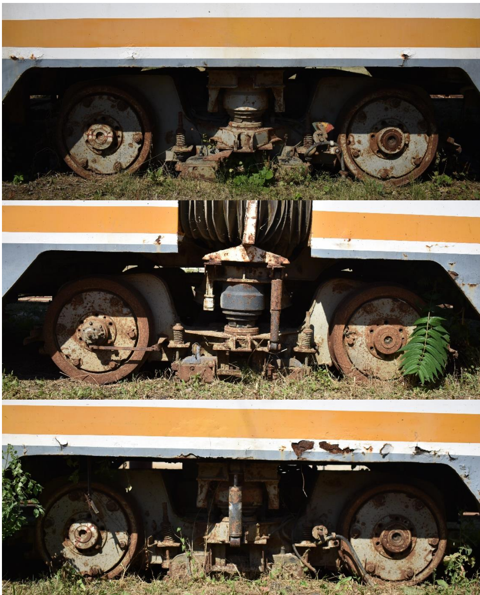
4042 – cele trei boghiuri prezintă urme de degradare accentuată, însă majoritatea componentelor s-au păstrat de-a lungul celor 10 ani. Restaurarea lor și a acestui vagon nu va pune probleme serioase.
