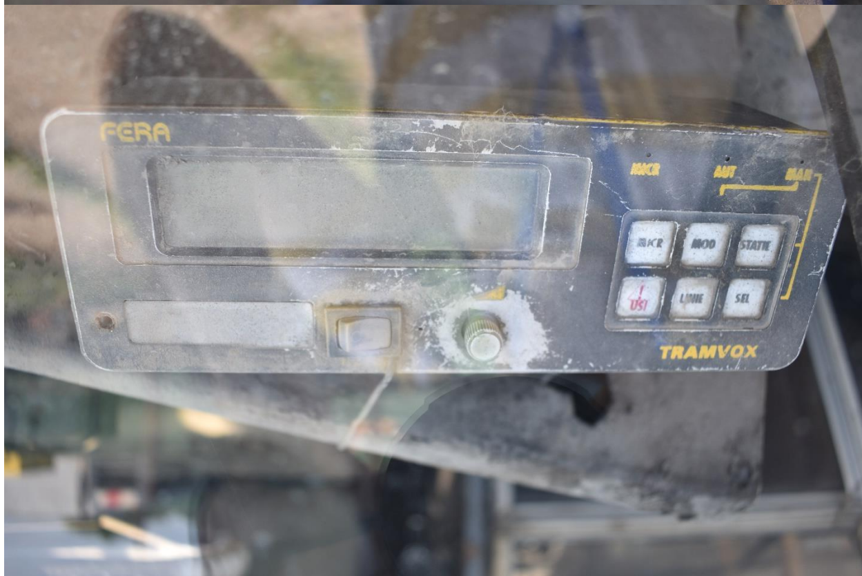
7459 – postul de conducere, prezent în condiții bune de preservare, aproape intact din punct de vedere al componentelor. Se remarcă echipamentul original pentru anunț al stațiilor „Tramvox”.
