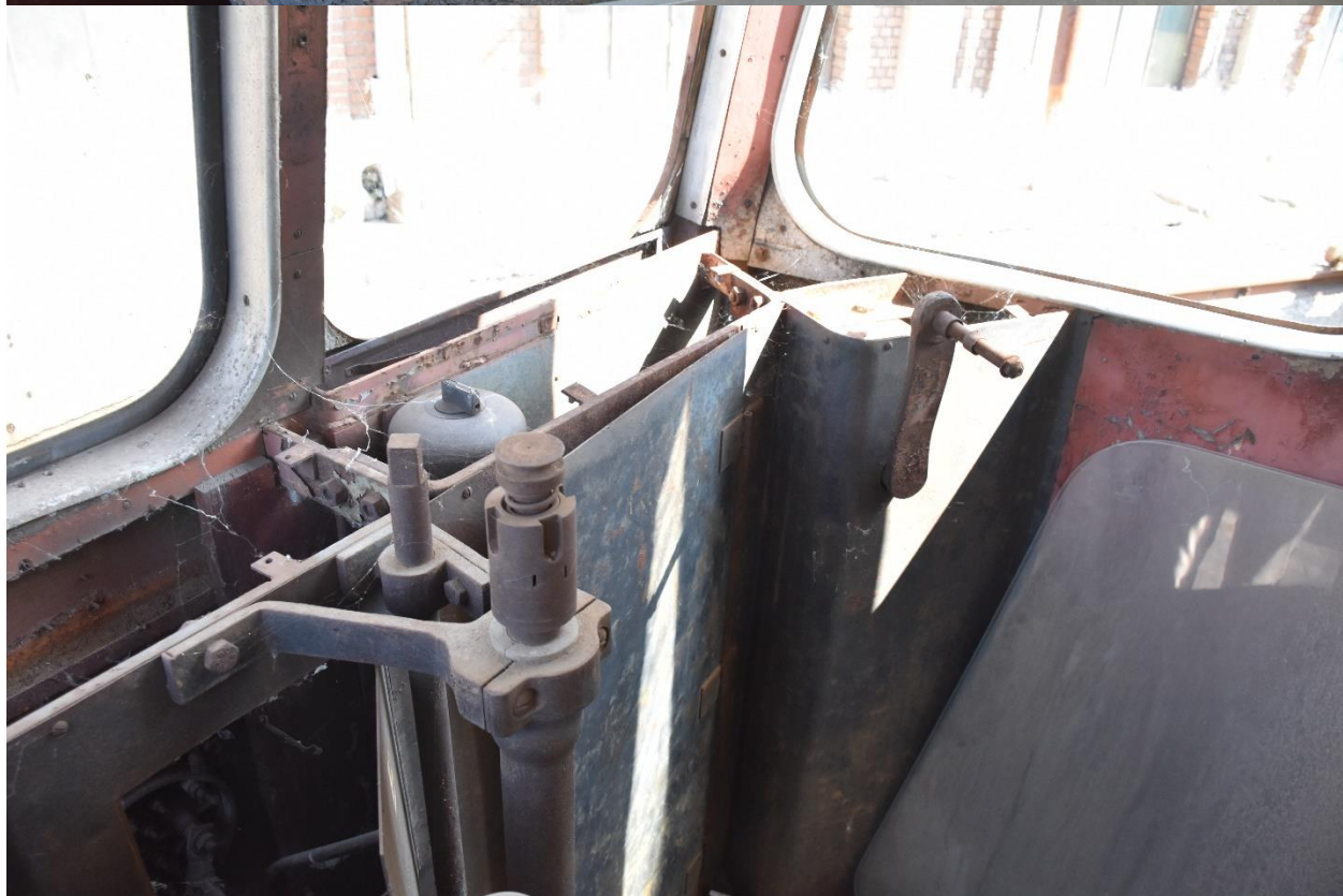
Gräf & Stift GP – unul din posturile de conducere, prezent în stare de degradare profundă.
