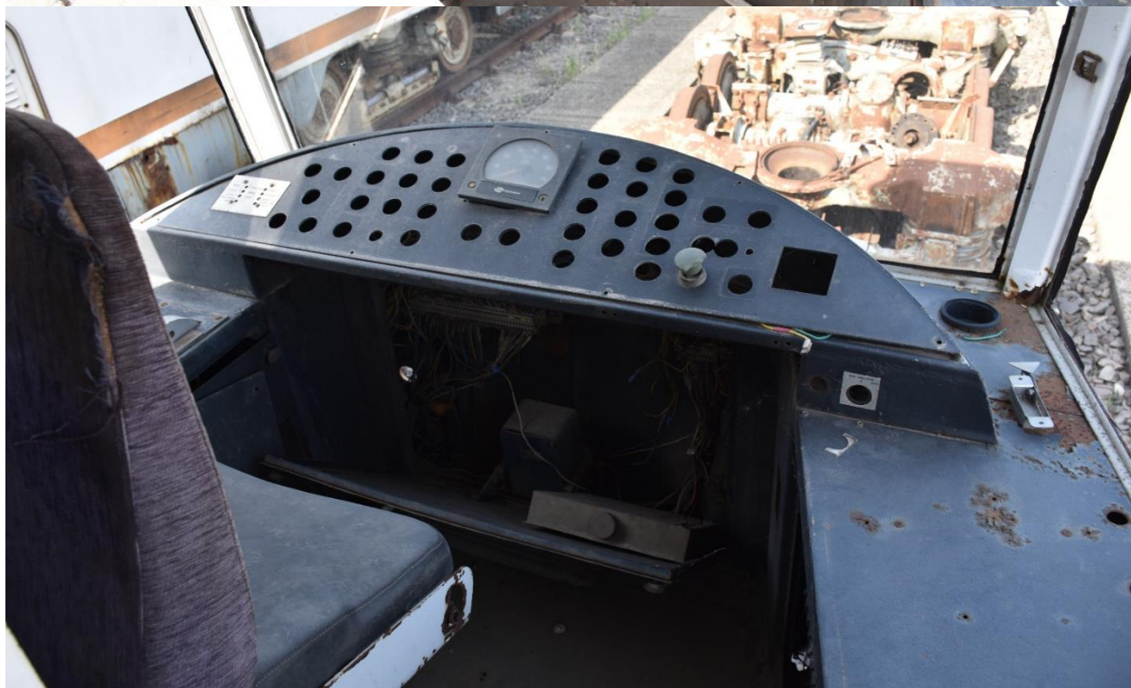
3001 – posturile de conducere, profund degradare, cu aproape toate componentele lipsă.
