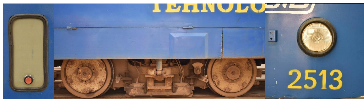
2513 – detalii ale exteriorului. Ansamblu buton ușă original, boghiu și farul de tip ELBA din partea frontală.
