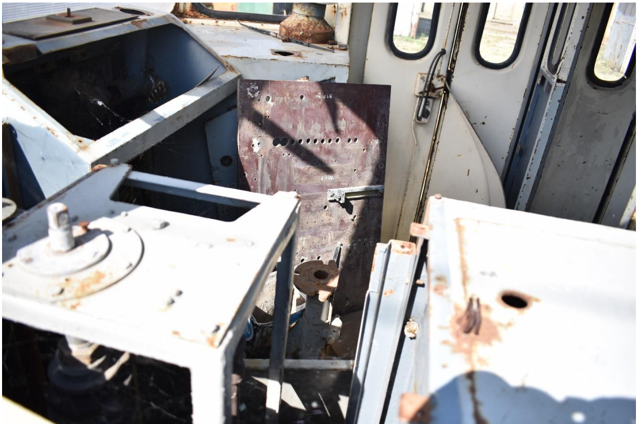
4042 – postul de conducere este devastat, necesitând o reconstituire completă. Fotografie realizată prin gaura geamului lateral, care lipsește.
