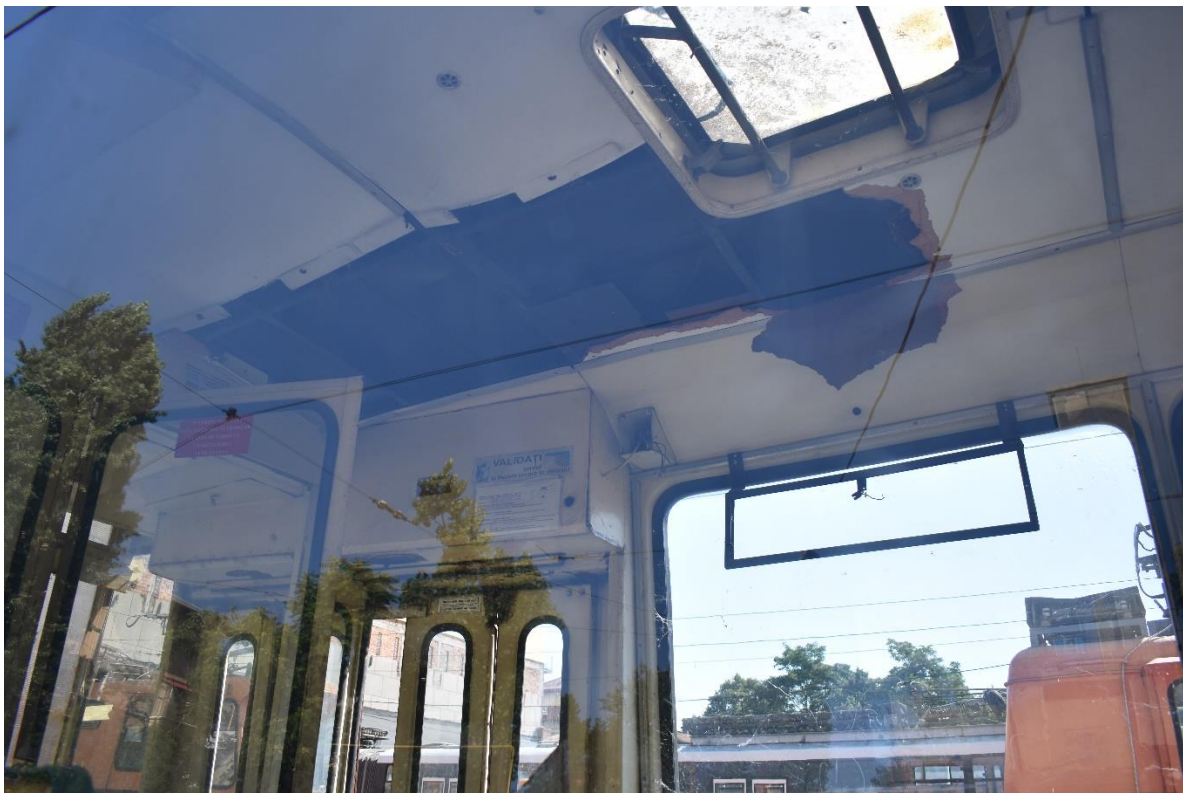
4042 – interiorul. Detaliu melamină deteriorată.
