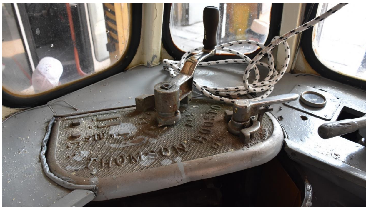
Echipamente originale Thomson (prezente pe mai multe pluguri unidirecționale din dotarea STB) ce pot ajuta la restaurarea lui S21.
