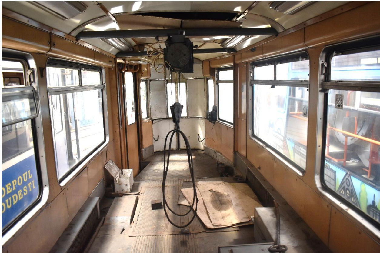
2663 – interiorul, ușor degradat, modificat în scop utilitar, lipsit aproape în totalitate de scaune sau de elemente de susținere pentru pasageri.
