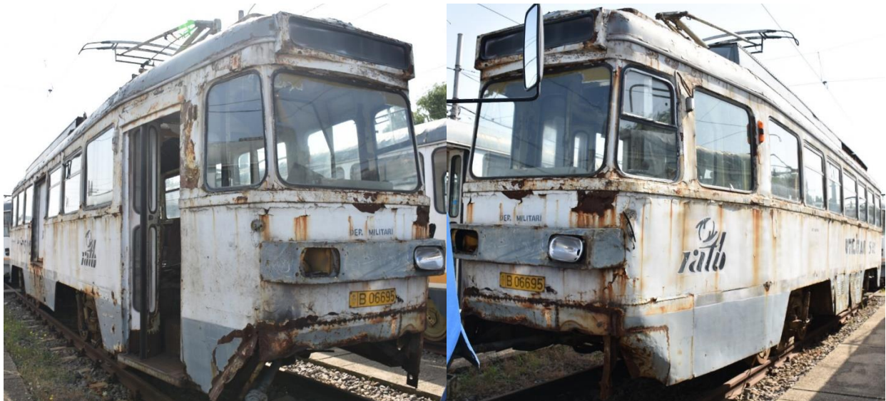
6096 – exteriorul, în condiție de degradare severă.
