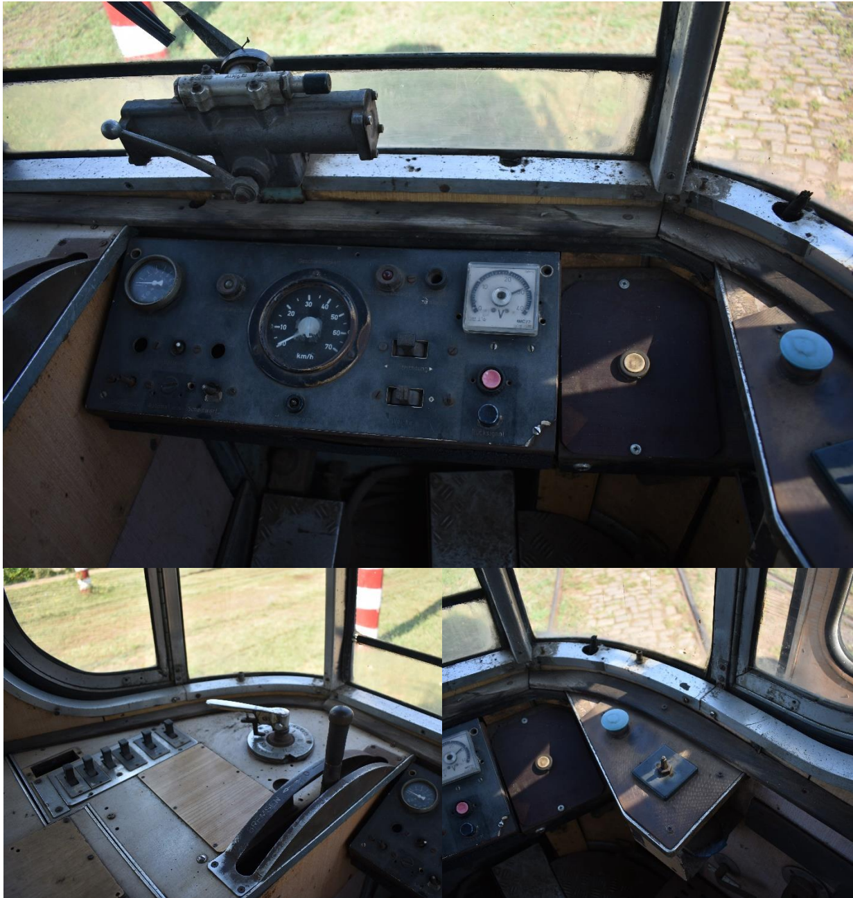
2612 – postul de conducere, degradat, cu foarte puține elemente originale rămase.
