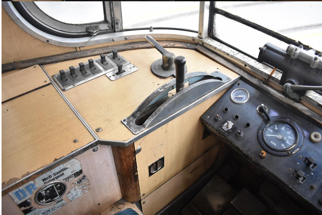
2513 – postul de conducere, ușor degradat, cu o parte din piese neoriginale. Starea actuală este asemănătoare cu starea sa de la momentul retragerii din circulație (2007).
