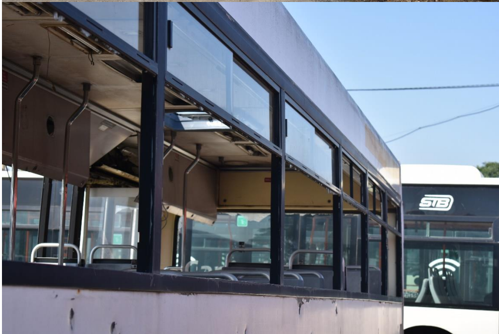
703 – exteriorul, degradat, având aproape toate geamurile sparte.
