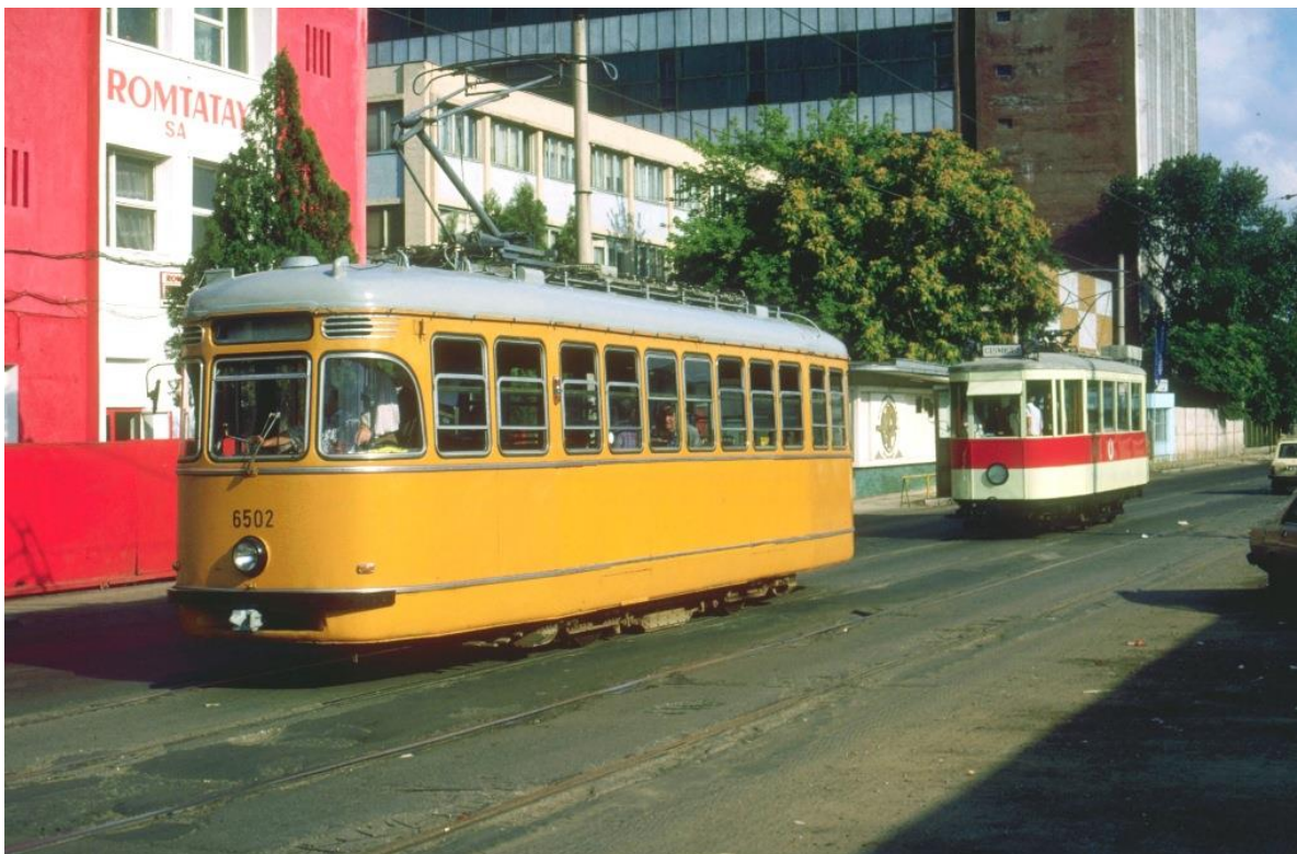
6502 efectuând o cursă specială în august 1996, surprins în dreptul halelor Obor. Se remarcă pantograful schimbat cu unul de tip V3A. Foto: Thomas E. Fischer.
