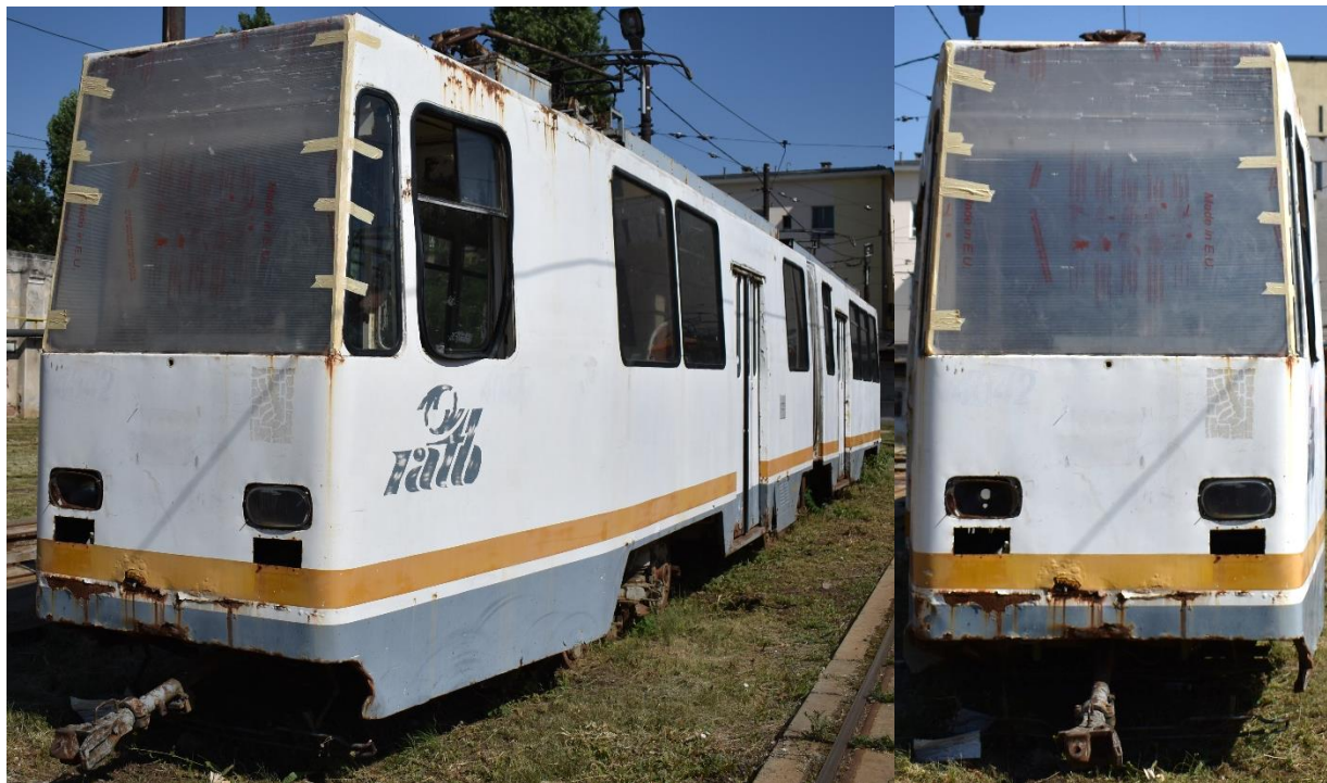
4042 – exterior, vedere din față. Golul lăsat de parbrizul sustras cu ani de zile în urmă a fost recent acoperit, însă distrugerile au fost deja făcute. Se remarcă alte piese lipsă, sustrate de către personalul depoului, cel mai probabil pentru a menține alte vehicule în stare de funcționare.
