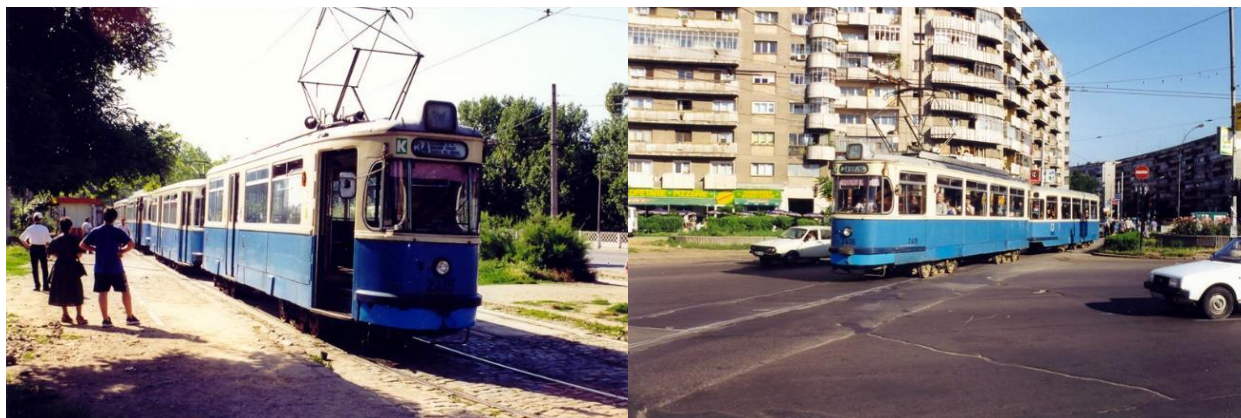
Motorul M4.65 2416 după echiparea cu boghiuri EP/V3A la București, anul 1999. Foto: Yuri Maller.
