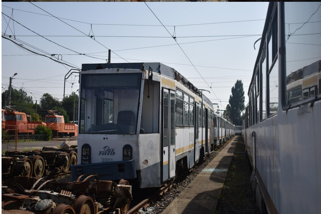
3001 – exteriorul, în condiții de degradare accentuată, afectat de coroziune și cu o serie de componente sustrate.
