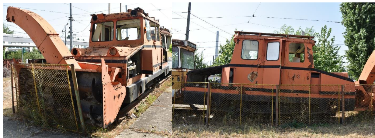
Turbofreza 03 – exteriorul, în stare de degradare, iar o parte din componente lipsesc.
