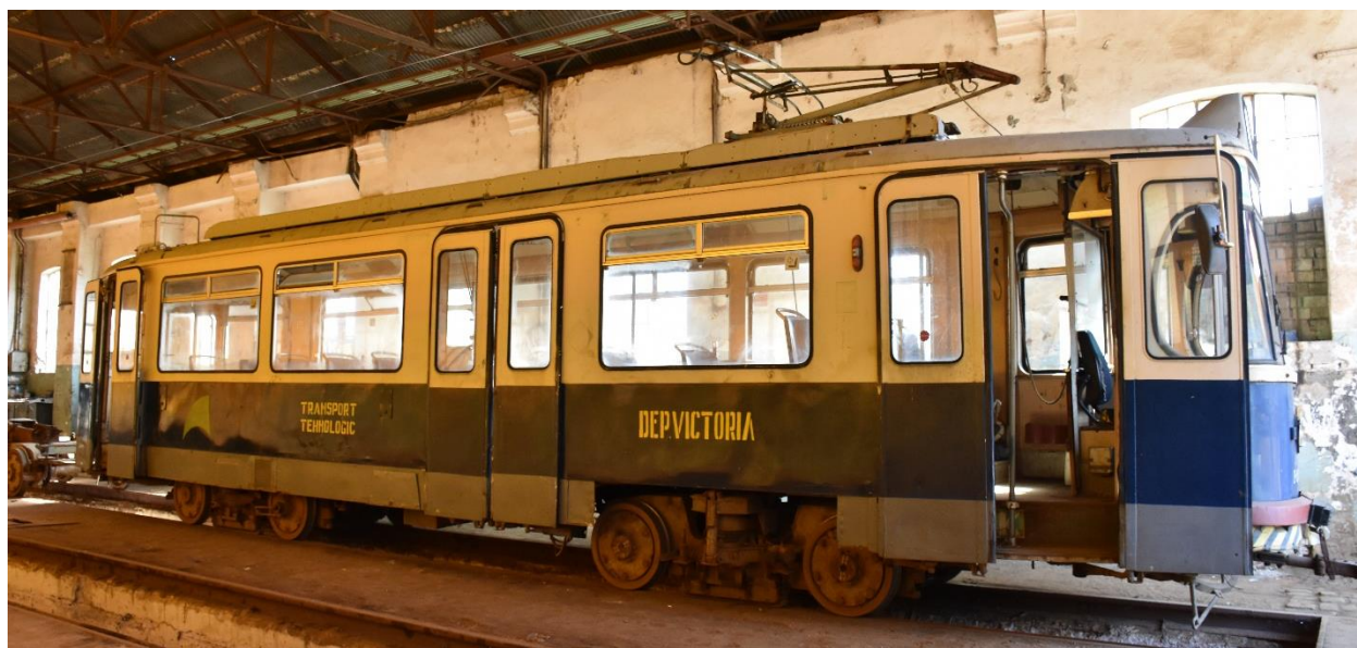
2535 – exteriorul în condiții acceptabile de prezervare. Măștile boghiului frontal sunt depozitate în interior.
