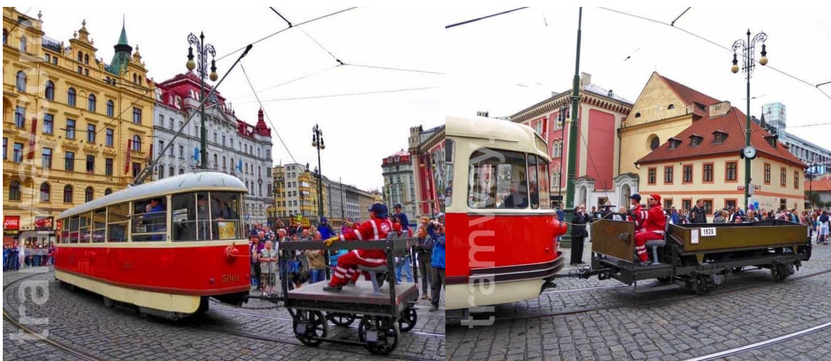
Vagonete și remorci utilizate la paradele din Occident pentru pilotarea sistemului de alimentare de la rețea al tramvaielor. Foto: tramway.com.
