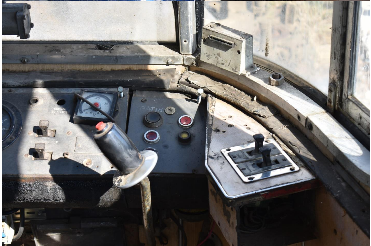
2670 – postul de conducere, ușor degradat, cu o parte din componente lipsă sau neoriginale.
