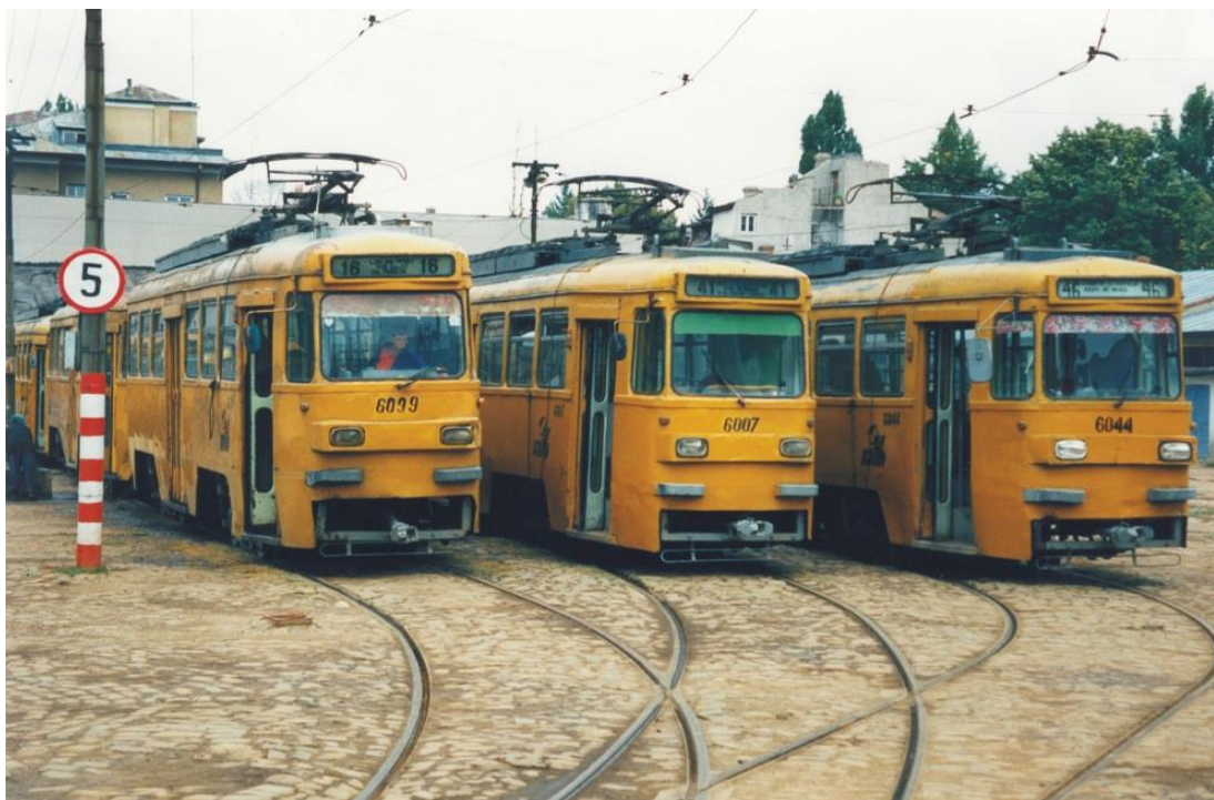
Tramvaie EP/V3A garate în depoul Victoria, august 1996. Se remarcă schema galben – portocalie introdusă la finalul anilor 1980, parbrizul cu montanți și decupaje mari la boghiuri. Foto: Joachim Kaddatz.
