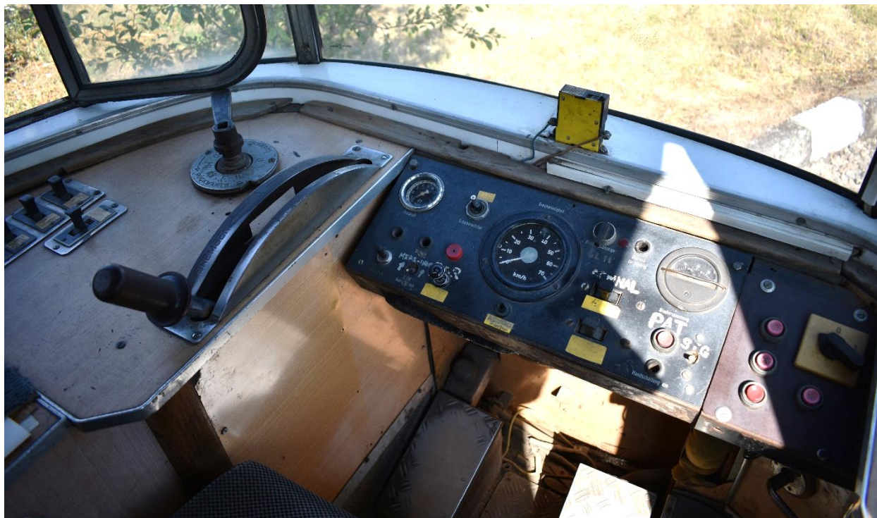
2614 – postul de conducere, în stare acceptabilă. O parte din componente lipsesc sau sunt neoriginale.
