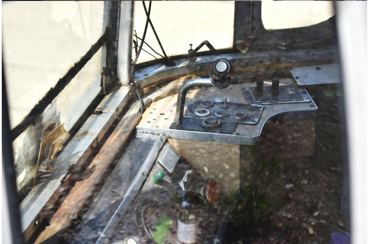
2416+3474 – postul de conducere, în stare acceptabilă, cu o parte din componente lipsă sau neoriginale.
