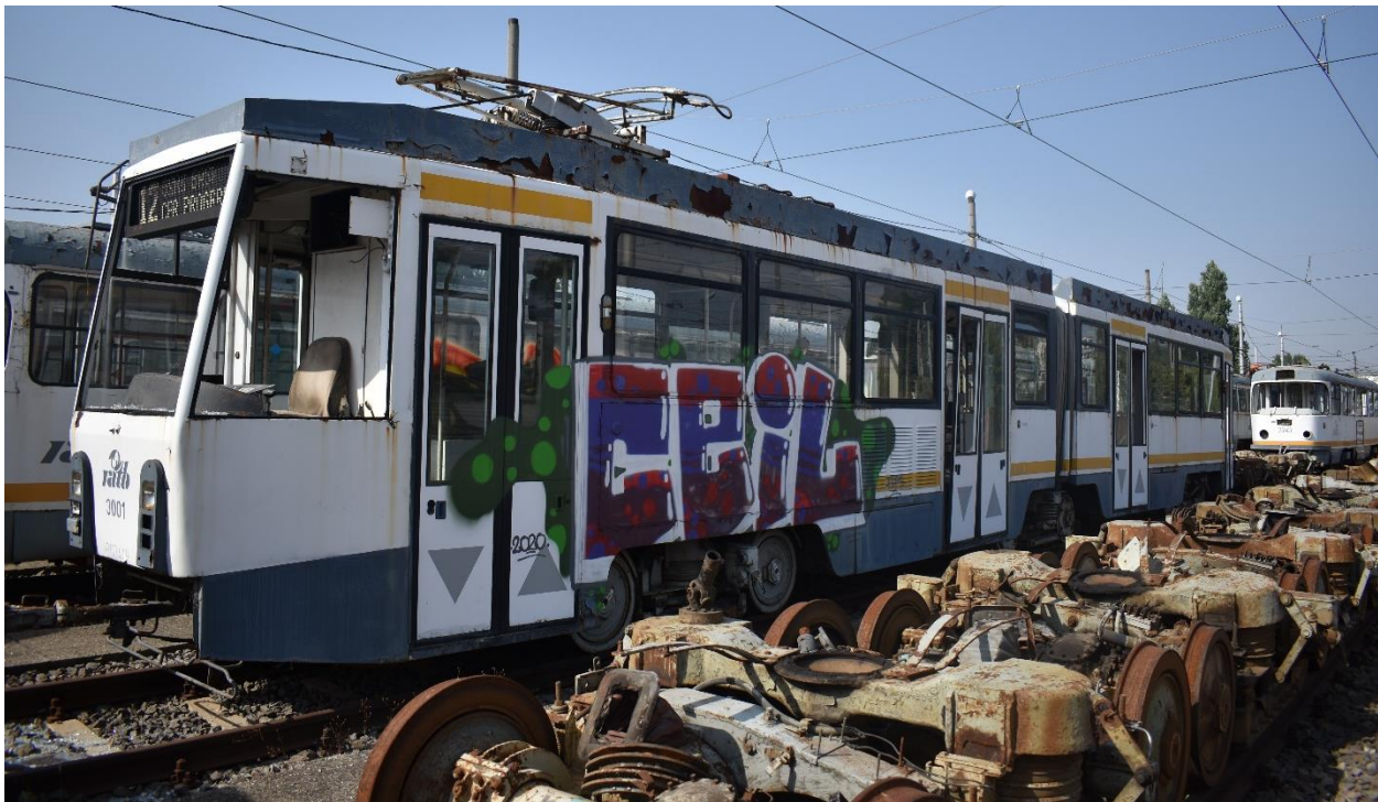
3001 – exteriorul, în condiții de degradare accentuată, afectat de coroziune și cu o serie de componente sustrase.
