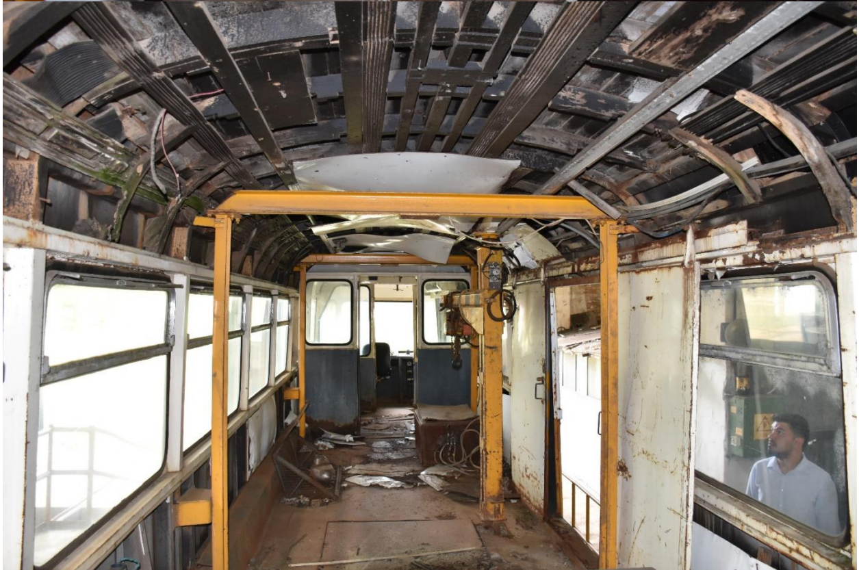
6089 – interiorul, în stare de degradare.
