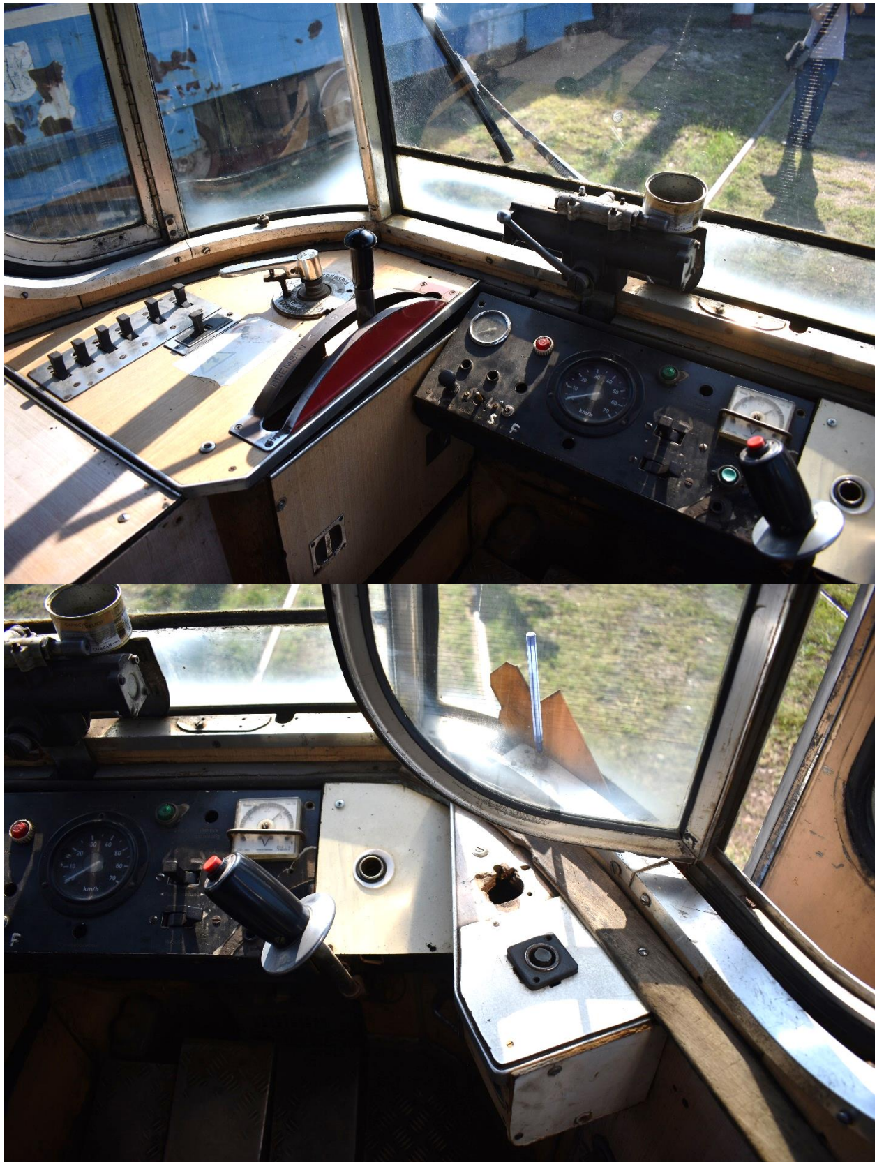
2523 – postul de conducere peticit cu materiale neoriginale. Majoritatea componentelor lipsă / neoriginale.
