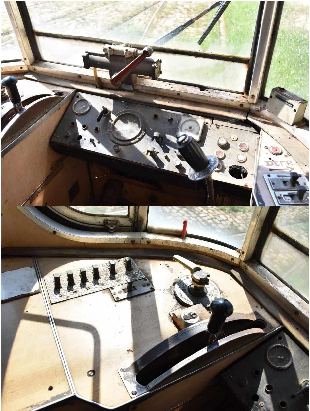
2518 – postul de conducere degradat, cu o serie de componente lipsă sau neoriginale.
