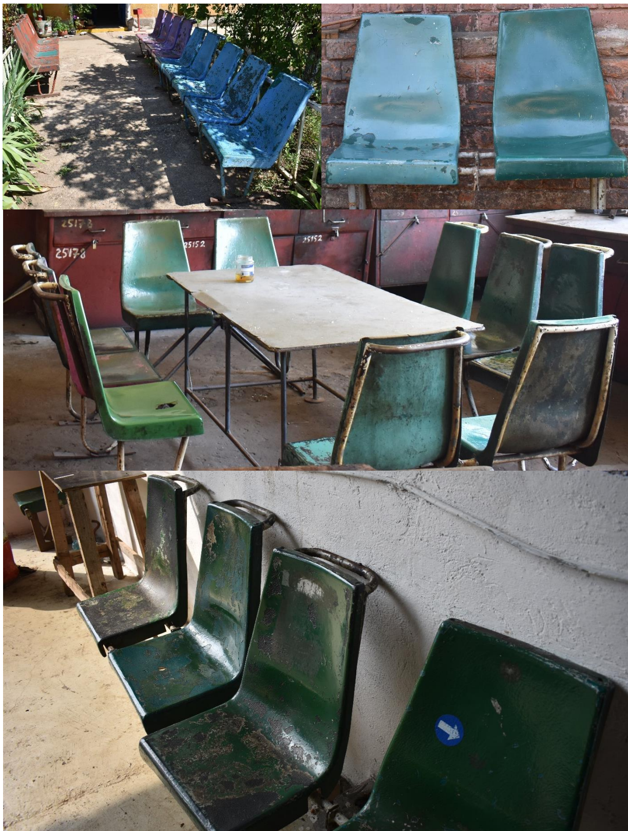
Scaune provenite de la tramvaiele V2A și V2A-2S casate, ce pot fi folosite pentru restaurarea vagonului 4042, alături de piesele ce se află deja în interiorul său. Fotografii realizate în depoul Victoria (stânga), URAC (dreapta), depoul Titan (mijloc) și depoul Colentina (jos).
