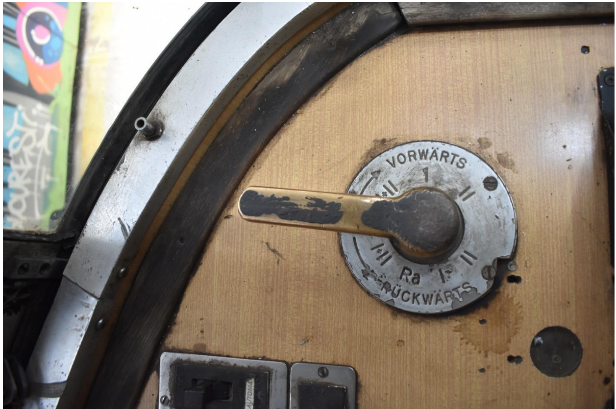
2663 – detalii ale postului de conducere. Maneta și butonul pentru comanda patinei sunt originale, iar maneta reversorului este originală.
