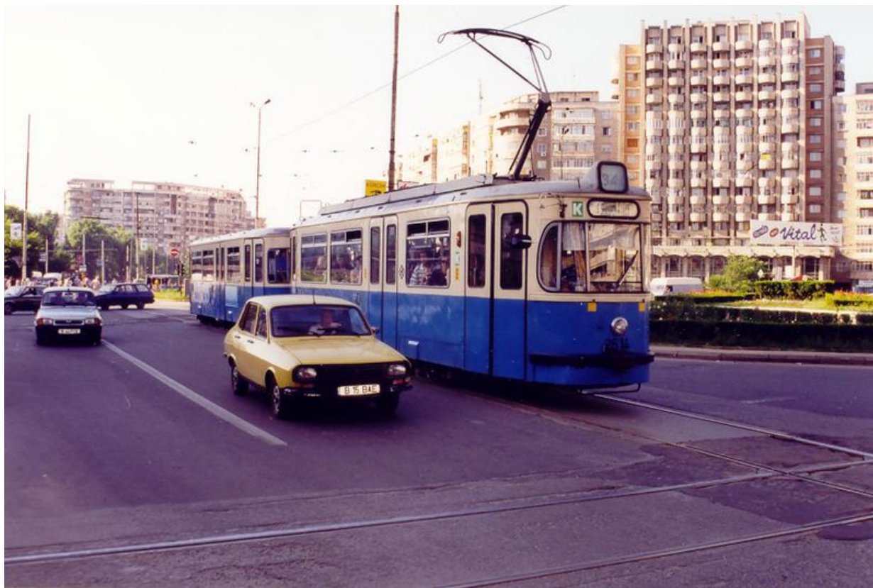
2614+3522, având trenul de rulare original, format din 3 axe și pantograful original. Obor, anul 1999. Foto: Yuri Maller.
