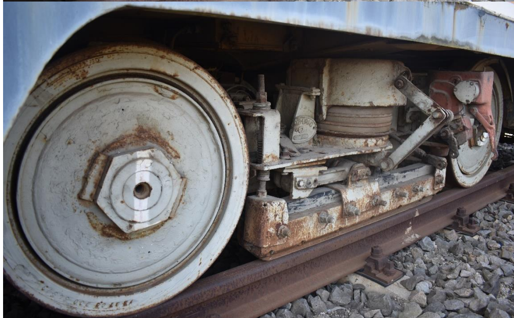
3001 – cele 3 boghiuri, afectate de coroziune, însă în condiții potrivite pentru restaurare, cu majoritatea componentelor încă prezente.
