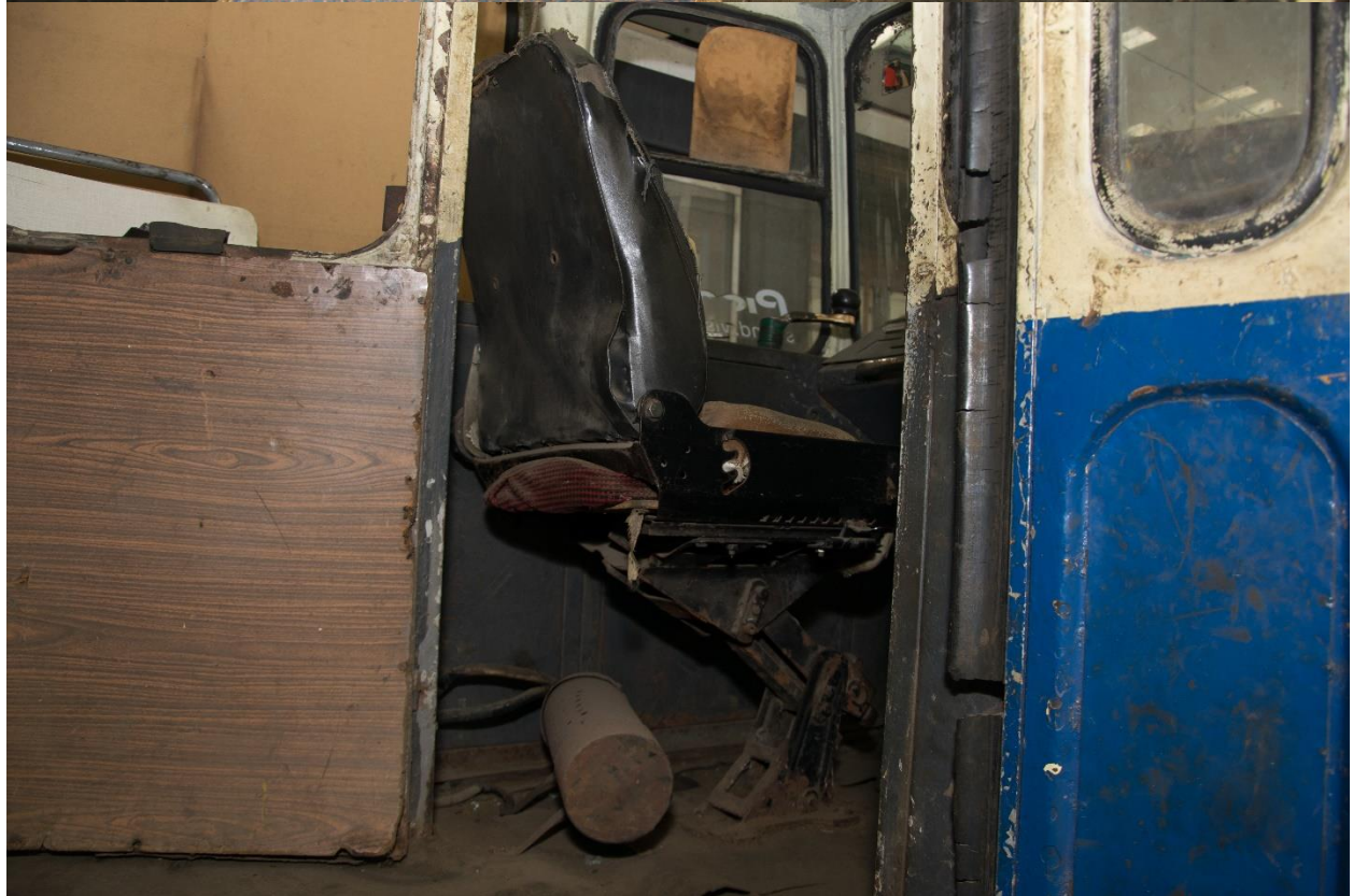
6090 – postul principal de conducere, descompletat aproape în totalitate de piese.
