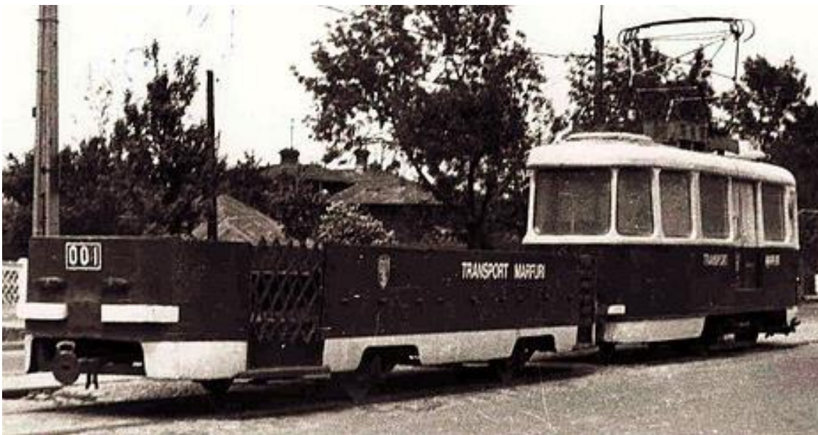
Remorca V12 001, transformată în scop utilitar pentru transportul mărfurilor, tractată de un tramvai V058 utilitar. Foto: autor necunoscut.
