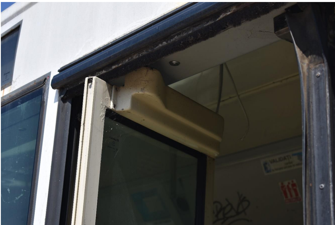
870 – detaliu ușă. Măștile ușilor au rămas în stare bună de conservare, însă garniturile de cauciuc au fost preluate și puse pe autobuze Citaro aflate în circulație, conform personalului autobazei.
