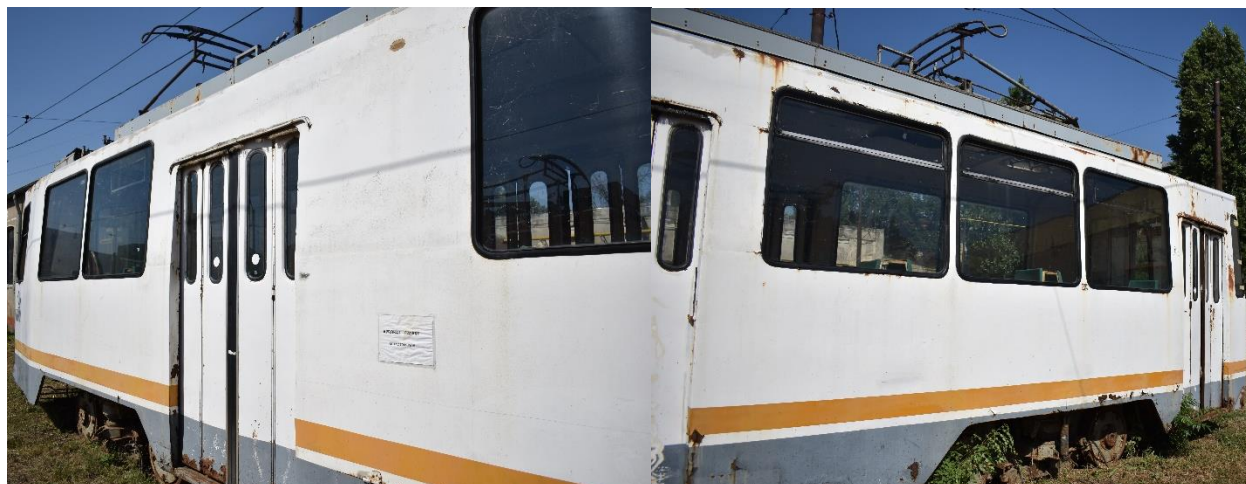
4042 – exterior, vedere din lateral. Sunt prezente urme de coroziune, însă tramvaiul se află în stare bună la exterior după 10 ani de conservare sub cerul liber.
