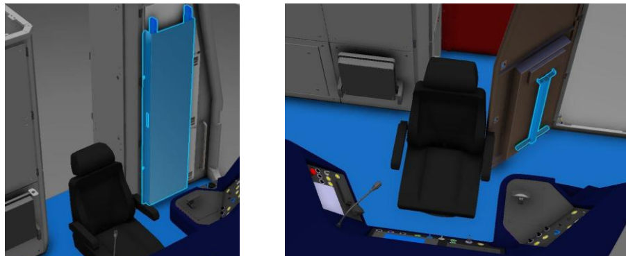
Figura 5-4. Scara de evacuare (stânga) și tija izolantă (dreapta).
