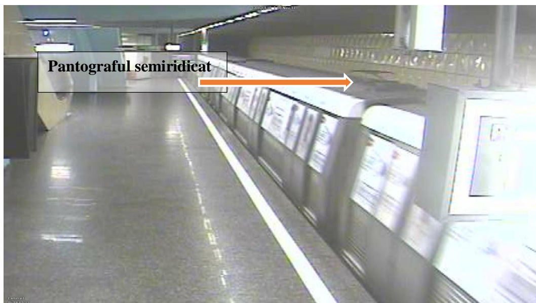
Fotografia 9: Trenul 3901 în stația Gorjului, captură după înregistrările video ale sistemului TV-CI aparținând Metrorex SA. Se observă pantograful în poziția semiridicată la vagonul 5 MP, la TEM 2110.
