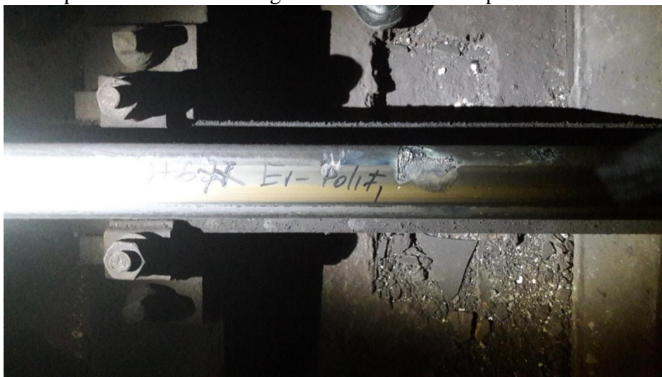
Fotografia 4 – urma arcului electric pe șină
