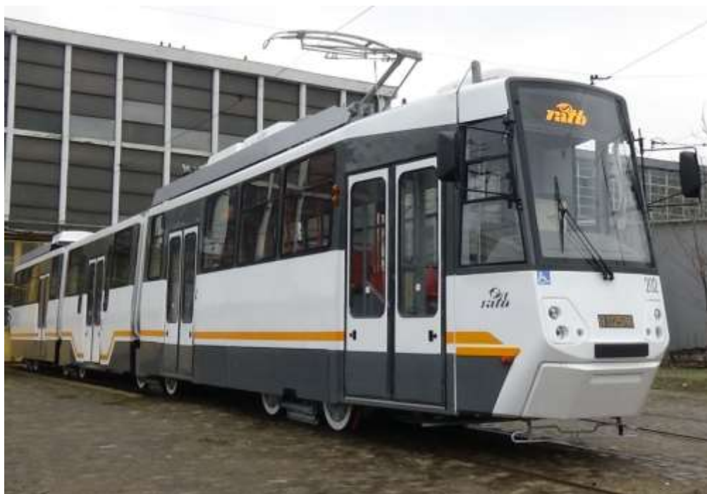
Tramvai tip V3A – PPC – CA cu podea coborâtă
